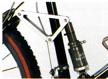
Nöll: Der German-A-Dämpfer wird über einen Alu-Hebel angelenkt
